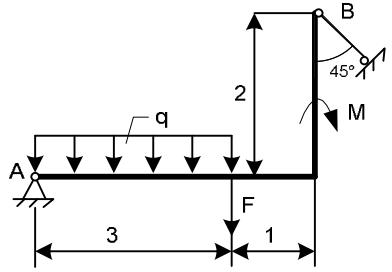
Приведенные на схеме нагрузки имеют следующие величины:  $G=10\text{kH}$ , сила  $F=10\text{kH}$ , момент пары сил  $M=20\text{kH}\cdot\text{m}$ , интенсивность распределенной силы  $q=5\text{kH/m}$ , весом тела следует пренебречь. Определить реакции опор.
