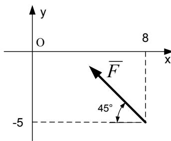
Модуль силы  $F$  равен 30 Н. Определить момент силы относительно точки О.
