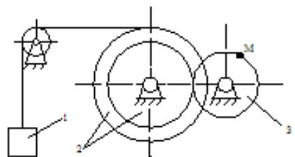
При заданном уравнении движения тела  $3 - \varphi_3(t) = 0,5t^3 - 2t^2$  и радиусах  $R_2 = 20\text{см}$ ,  $r_2 = 15\text{см}$ ,  $R_3 = 10\text{см}$  и  $t = 2\text{с}$  определить скорость точки М.
