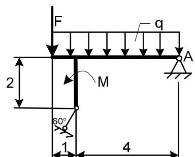
Приведенные на схеме нагрузки имеют следующие величины:  $G=10\text{kH}$ , сила  $F=10\text{kH}$ , момент пары сил  $M=20\text{kH}\cdot\text{m}$ , интенсивность распределенной силы  $q=5\text{kH/m}$ , весом тела следует пренебречь. Определить реакции опор.
