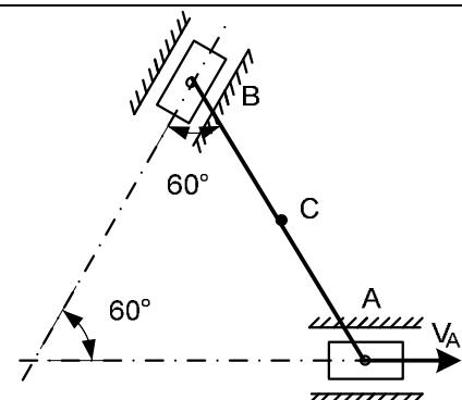
Для механизма, состоящего из шатуна АВ длиной 2м и двух ползунов, по заданной величине скорости ( $V_A = 1$  м/с) ползуна А определить скорость ползуна В и угловую скорость шатуна.
