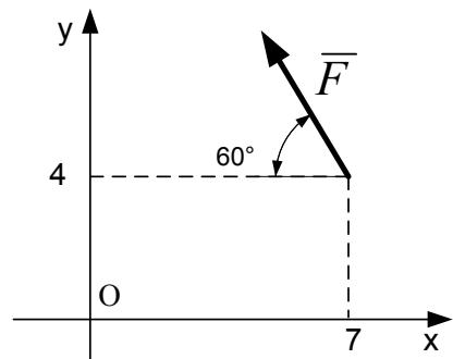
Модуль силы  $F$  равен 20 Н. Определить момент силы относительно точки О.
