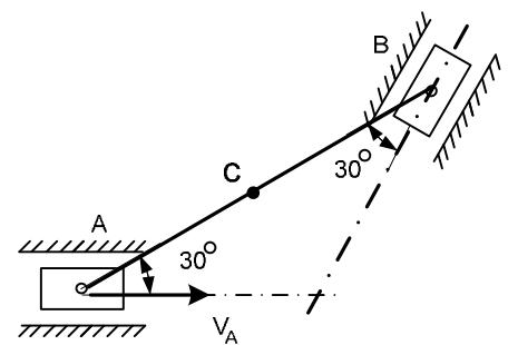
Для механизма, состоящего из шатуна АВ длиной 2м и двух ползунов, по заданной величине скорости ( $V_A = 1$  м/с) ползуна А определить скорость ползуна В и угловую скорость шатуна.
