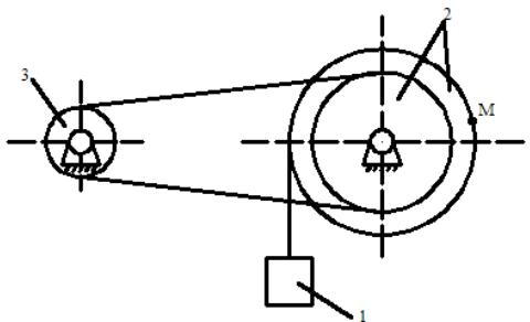
При скорости  $V_{1x} = -0,5$  м/с и радиусах  $R_2 = 100$  см,  $r_2 = 60$  см,  $R_3 = 75$  см определить скорость точки М.
