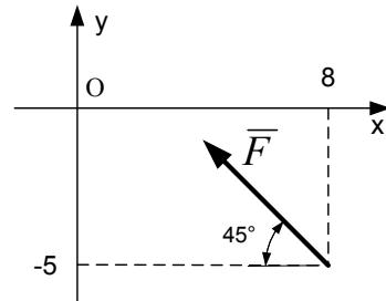
Модуль силы  $F$  равен 30 Н. Определить проекции силы на оси  $x, y$ .
