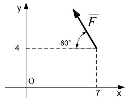
Модуль силы  $F$  равен 20 Н. Определить проекции силы на оси  $x, y$ .
